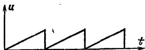
Рис. 292. «Пилообразная» форма напряжения, накладываемого на вертикальные пластины электроннолучевого осциллографа для осуществления развертки по оси времени
