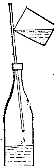
Рис. 415. Применение стеклянной палочки для наливания воды в сосуд с узким горлом
