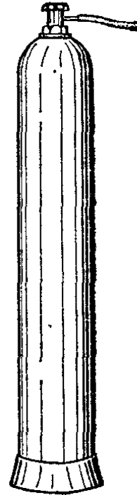
Рис. 375. Стальной баллон для хранения сильно сжатых газов
