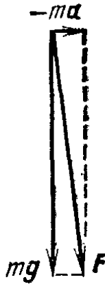
Рис. 315. Сумма F сил mg и -ma отклонена в сторону, обратную ускорению a
