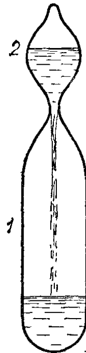
Рис. 479. В сосудах 1 и 2 находятся вода и ее пар, воздух отсутствует; вода из сосуда 2 полностью стекает в сосуд 1
