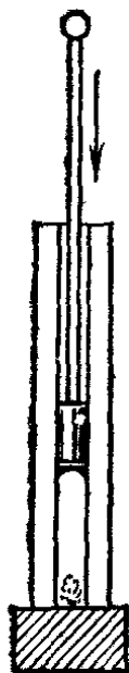
Рис. 378. Быстро вдвигая поршень в толстостенную стеклянную трубку, мы заставляем вспыхнуть внутри трубки легко воспламеняющуюся ватку
