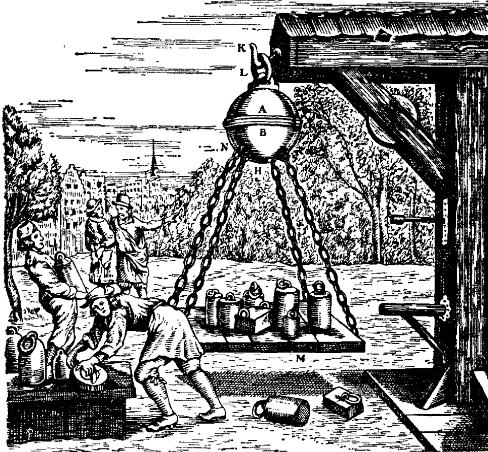
Рис. 278. Гравюра из книги Герике «Новые магдебургские опыты». Разрывание полушарий подвешенным грузом
