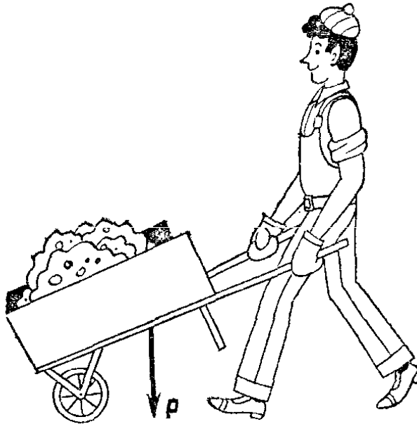
Рис. 139. Тачка как рычаг
