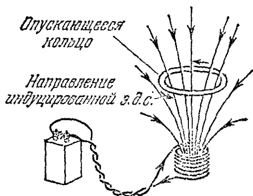
Рис. 7.12. Во время опускания кольца увеличивается поток сквозь кольцо, направленный вниз. Индуцированная э.д.с. будет, согласно закону Ленца, направлена по стрелкам, так как ток, текущий в этом направлении, создает поток, направленный вверх сквозь кольцо. Система противодействует происходящему изменению.
