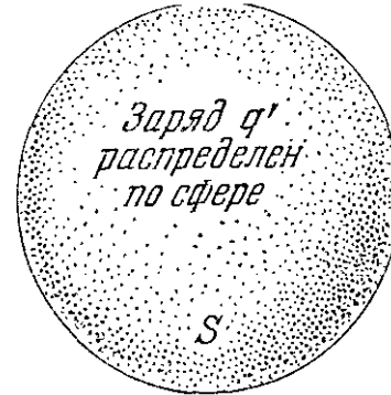
Рис. 2.21. Работа, требуемая для перенесения заряда q' и распределения его по сфере, равна произведению q' на среднее значение потенциала, обусловленного зарядом q , по той же сфере.
